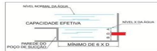
Figura B.2: Tomada lateral de sucção para bomba principal
