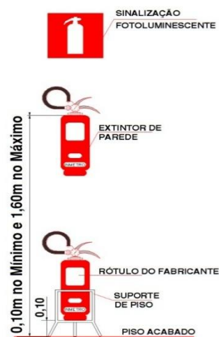
Figura 3: Detalhe de fixação e sinalização do extintor 7.2.1. Quantidade mínima de extintores exigidos:
